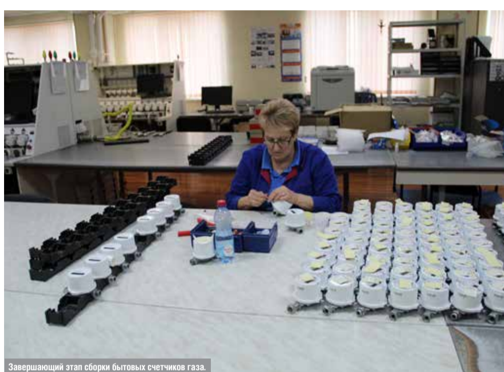
Завершающий этап сборки бытовых счетчиков газа.
