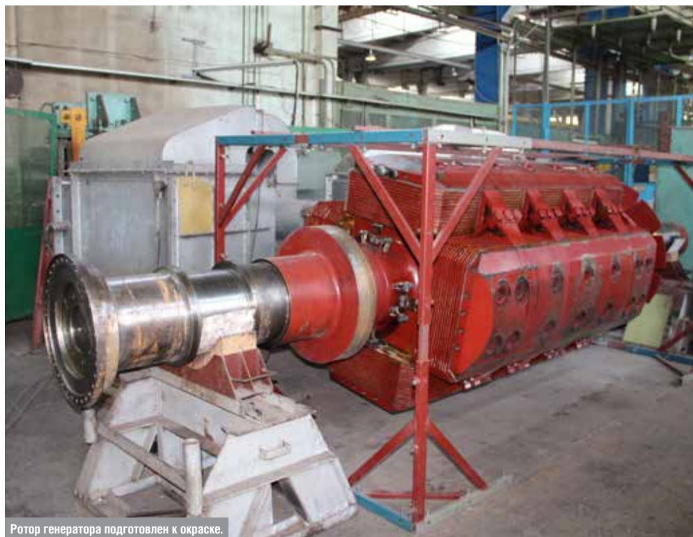
Ротор генератора подготовлен к окраске.
