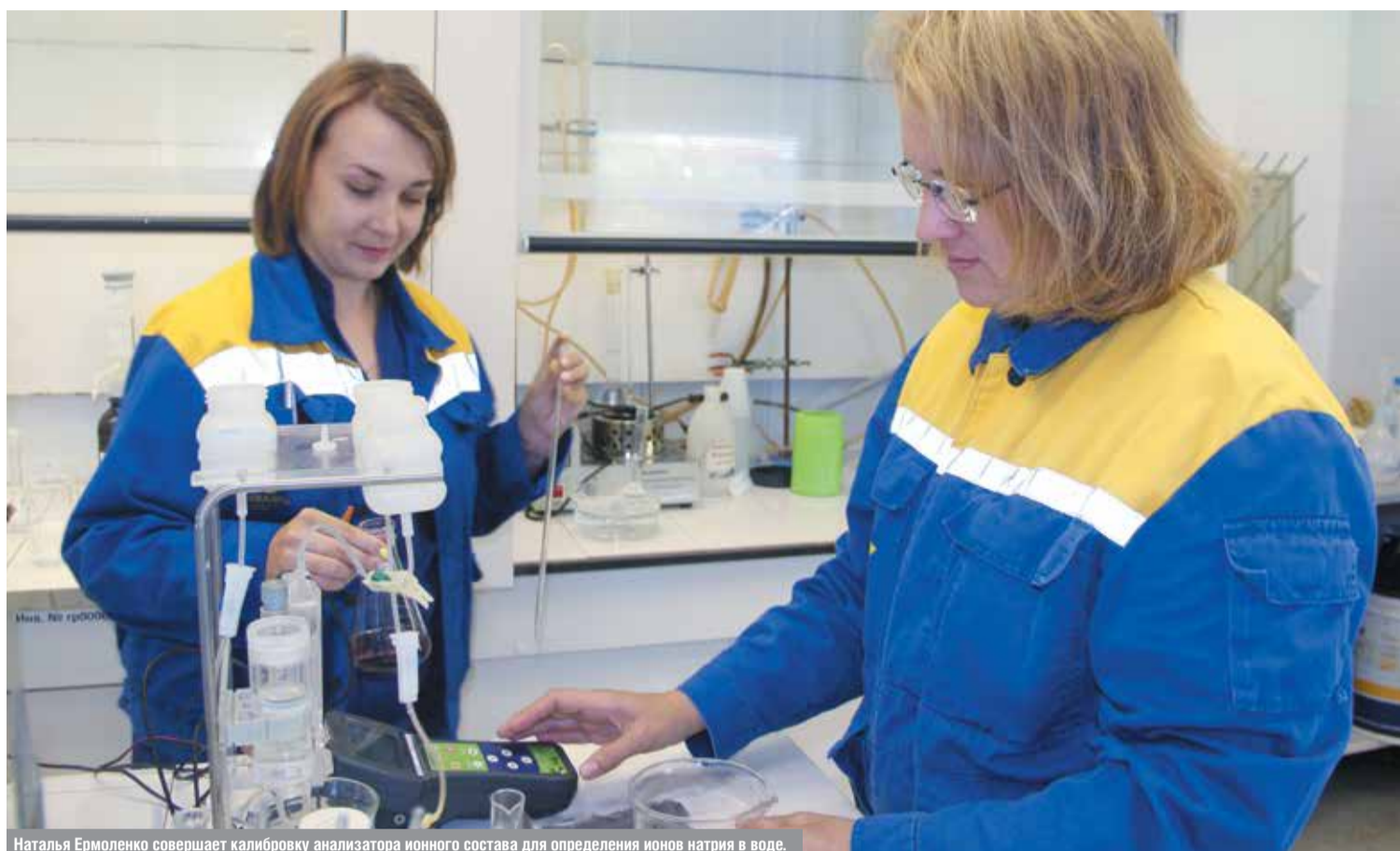
Наталья Ермоленко совершает калибровку анализатора ионного состава для определения ионов натрия в воде.
